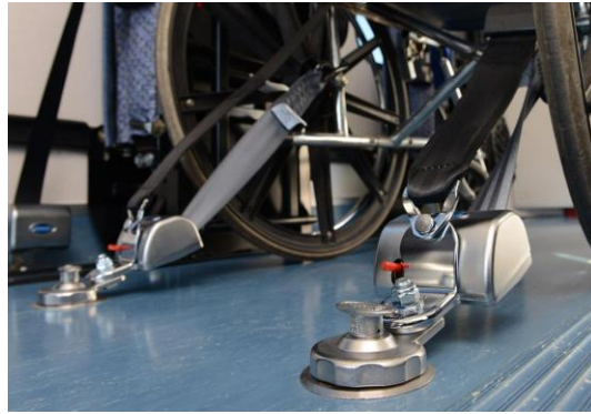
Fig. 2. 3. Modelo del anclaje tipo slide 'N Click [3].
