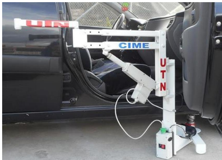
Fig. 2. 1. Diseño y construcción de una base portátil para un dispositivo para traslado de personas con discapacidad motriz entre sillas de ruedas y automóviles [1].
