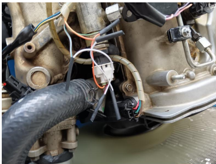
Figura 80. Prototipo de resina montado en un motor en condiciones reales de funcionamiento
