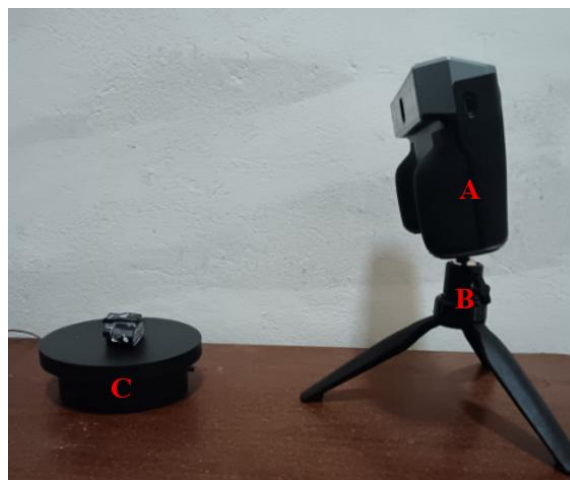
Figura 13. Preparación del equipo para la digitalización: A) Escáner B) Trípode C) Base giratoria
