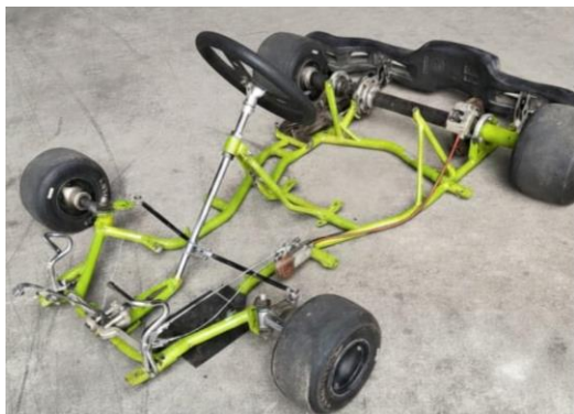
A) Plataforma de Pruebas: Chasis COMPKART.
