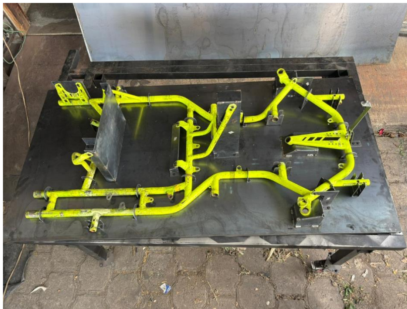
Figura 48. Montaje de las piezas diseñadas y el chasis de Go-Kart.
