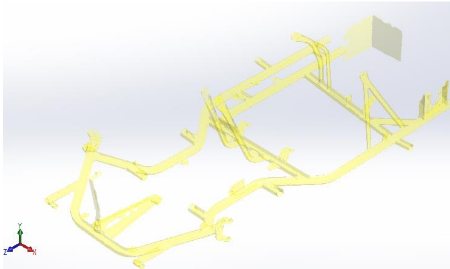
Figura 28. Referencia visual del chasis escaneado.
