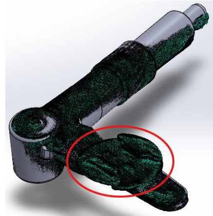
C). Superposición entre el diseño 3D y el escaneo.
