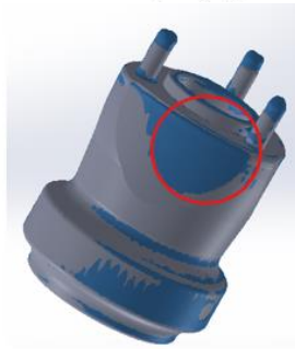
C). Superposición entre el diseño 3D y el escaneo.
