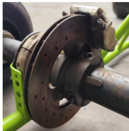
Figura 55. Implementación del disco de freno.
