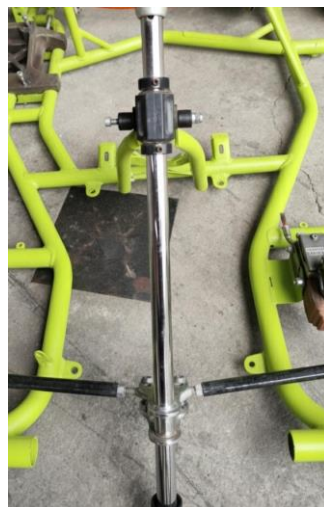
Figura 52. Implementación de la columna de dirección.
