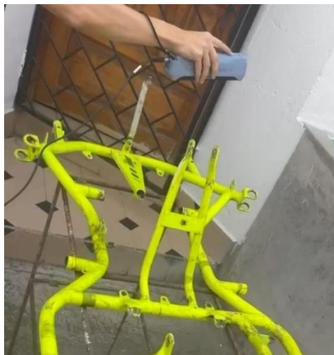
Figura 25. Escaneo del chasis.
