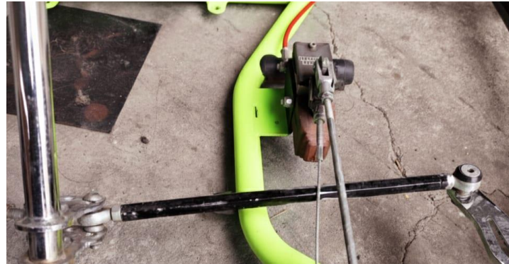
Figura 51. Implementación del brazo de dirección.
