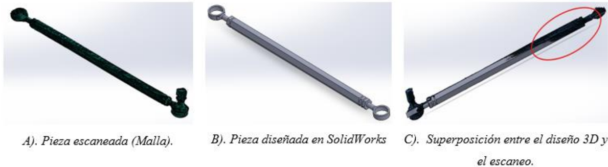
Figura 102. Escaneo 3D y diseño del brazo de dirección.
