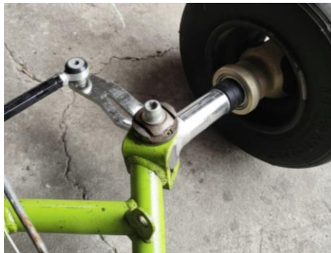
Figura 53. Implementación de la mangueta.
