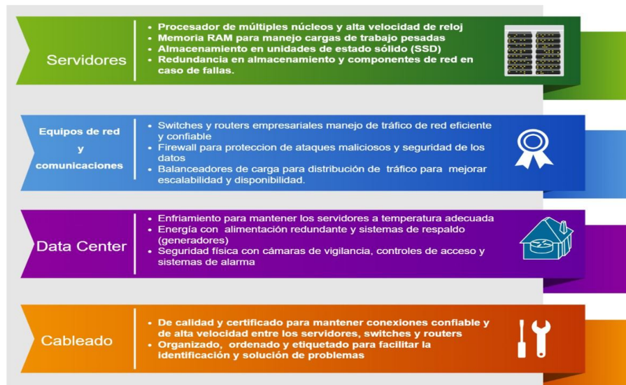
Figura 8. Componentes de hardware para servicio web
