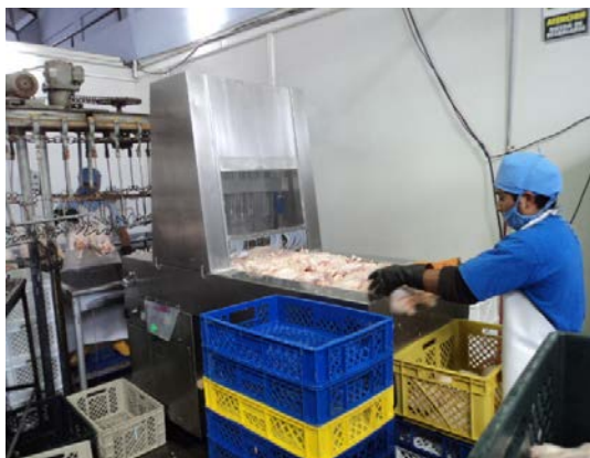
12. ADICIÓN DE SALMUERA MÉTODO DE INYECCIÓN
