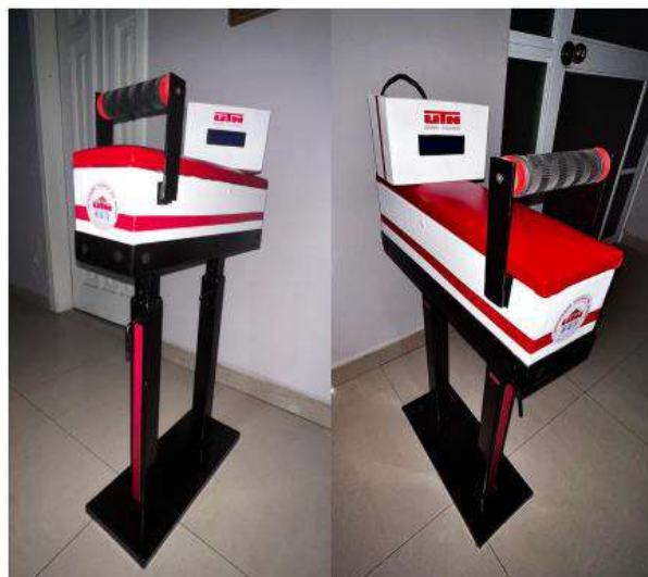
Fig. 2.2. Medidor de fuerza del miembro superior [3].
