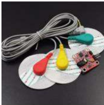
Fig. 2.14 Sensor de señal muscular EMG [18].
