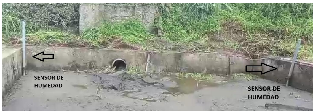
Figura 42: Ubicación de los sensores de humedad dentro de la fosa para el monitoreo de los desechos orgánicos.
