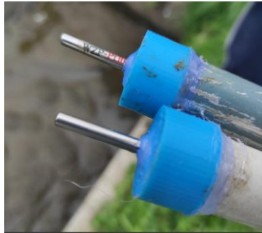
Figura 35 Limpieza del sensor PT100 (Sensor de temperatura)
