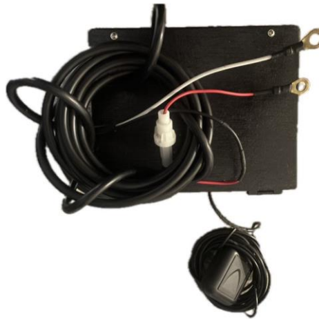
Figura 18. Carcasa final del sistema GPS autónomo fuera del vehículo.
