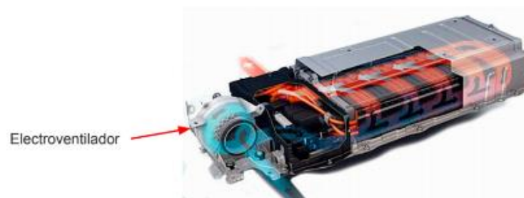
Figura 8. Sistema de refrigeración de aire forzado para batería de HV.
