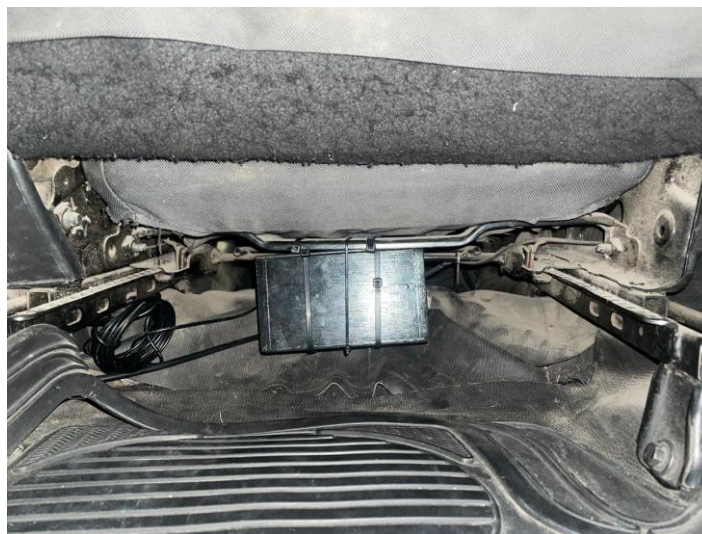
Figura 19. Ubicación del sistema GPS autónomo bajo el asiento del conductor
