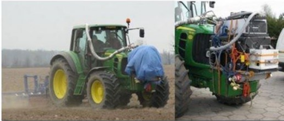
Figura 5. Máquina agrícola con sistema PEMS
