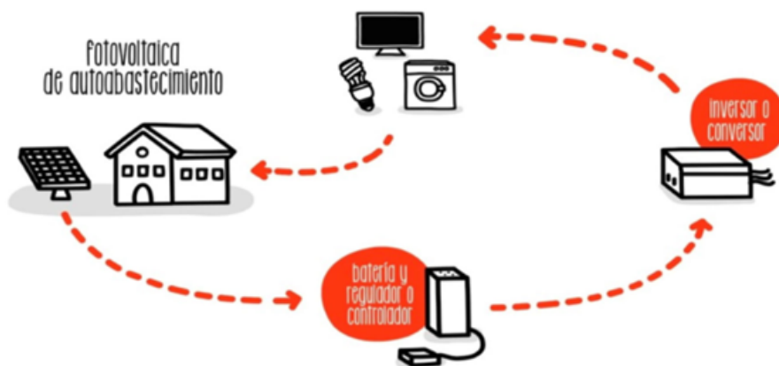
Figura 2.7: Sistema fotovoltaico autónomo [7]
