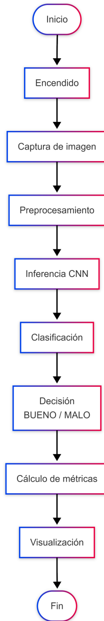
Figura 3.7: Diagrama de flujo del funcionamiento general del sistema de clasificación.
