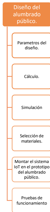
Fig 13. Flujograma para el diseño de la red de alumbrado público general con base a tecnología IoT.
