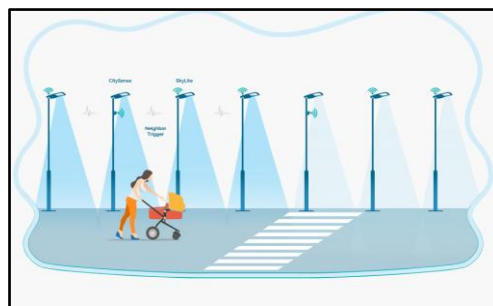
Fig 9. Luminarias públicas con sensores de movimiento [23].
