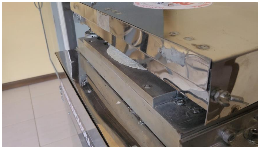
Fig. 34. Prueba de la matriz de corte. (A) Posición inicial.
