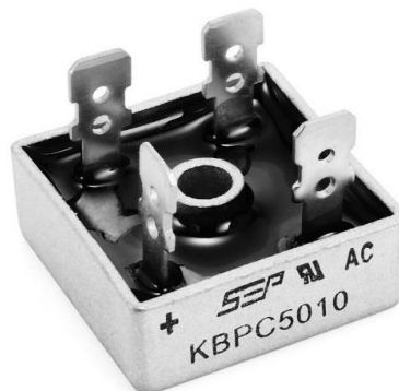
Fig. 15. Puente rectificador: KBPC5010 [35].
