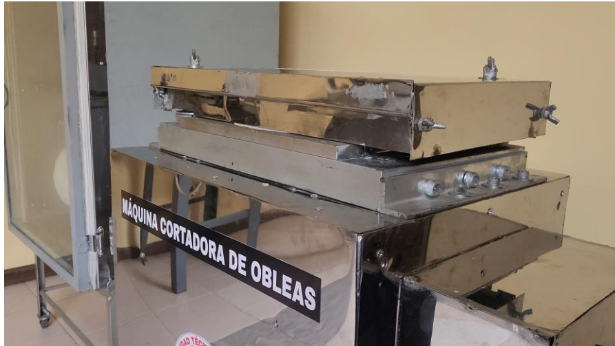
Fig. 35. Prueba de la matriz de corte. (B) Punto inferior.
