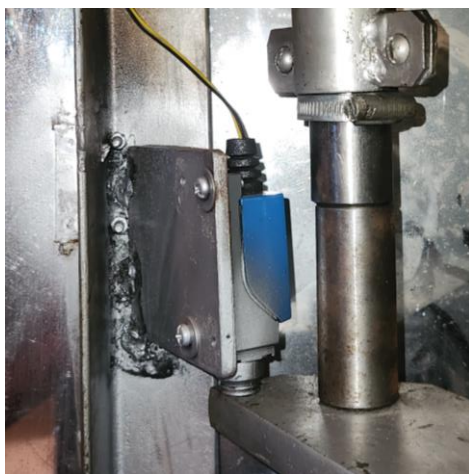
Fig. 24. Colocación del final de carrera en la máquina.
