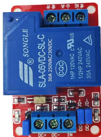
Fig. 13. Relé Electromecánico SLA-05VDC-SL-C [31].
