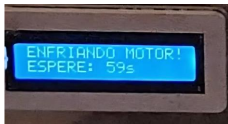
Fig. 41. Pantalla LCD que muestra la cuenta regresiva de enfriamiento.
