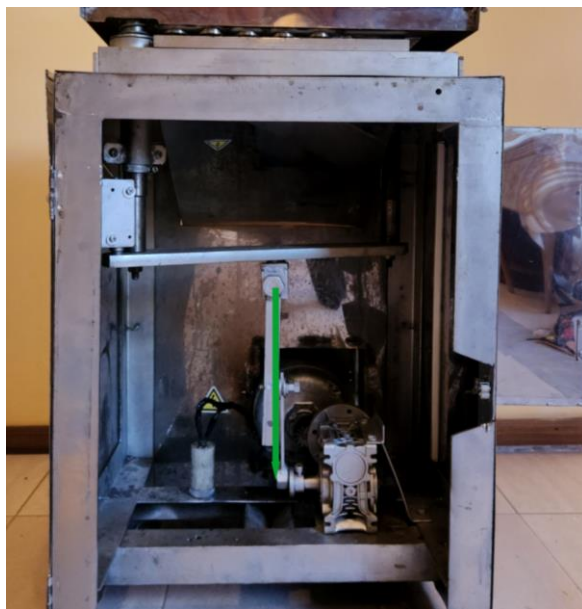
Fig. 27. Imagen del mecanismo biela-manivela posicionado correctamente.
