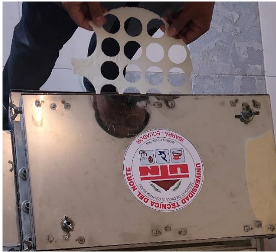
Fig. 8 Retiro del excedente de la lámina.
