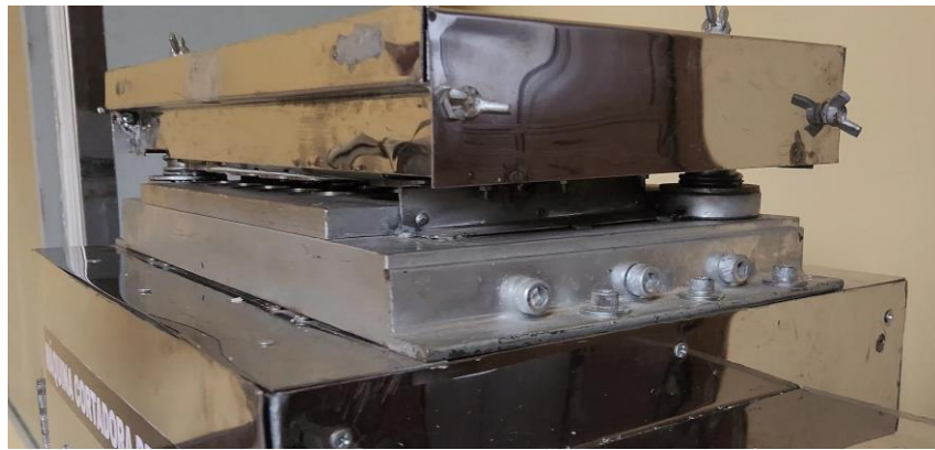
Fig. 36. Prueba de la matriz de corte. (C) Retorno y frenado en el punto superior.
