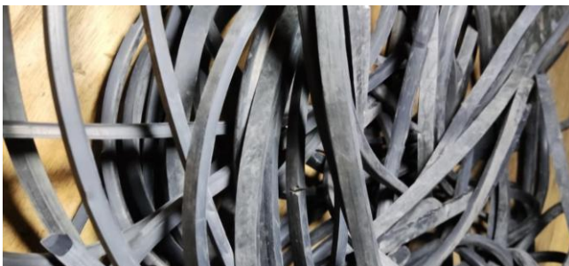
Figura 43 Tiras sustraídas con ayuda de la herramienta de desbaste.
