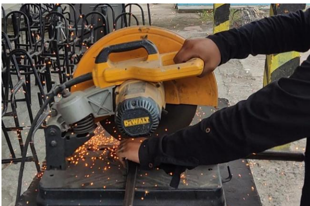
Figura 28 Proceso de corte de material.
