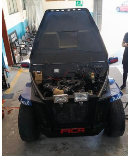
Figura 13. Puesta a punto del vehículo Ford 4.0L V6, instalado en un prototipo
