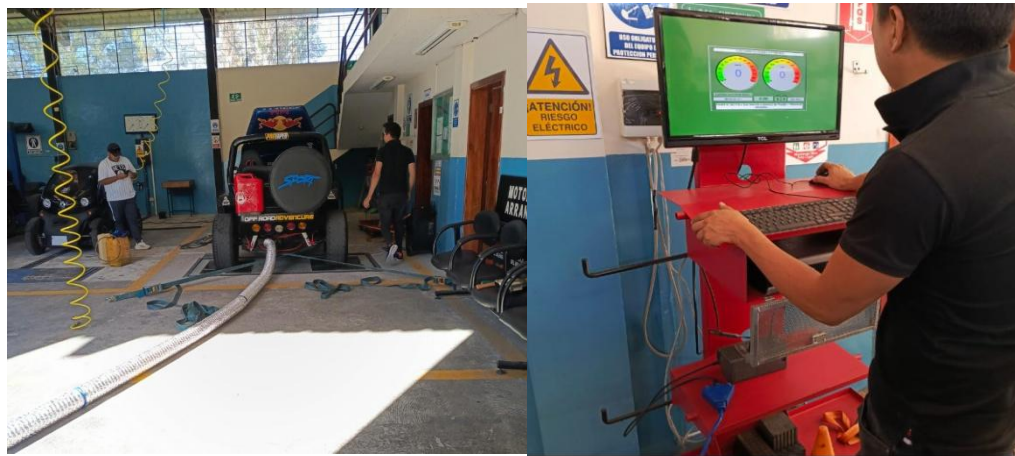
Figura 15. Pruebas con los combustibles Extra de 85 y Súper de 95 en el dinamómetro
