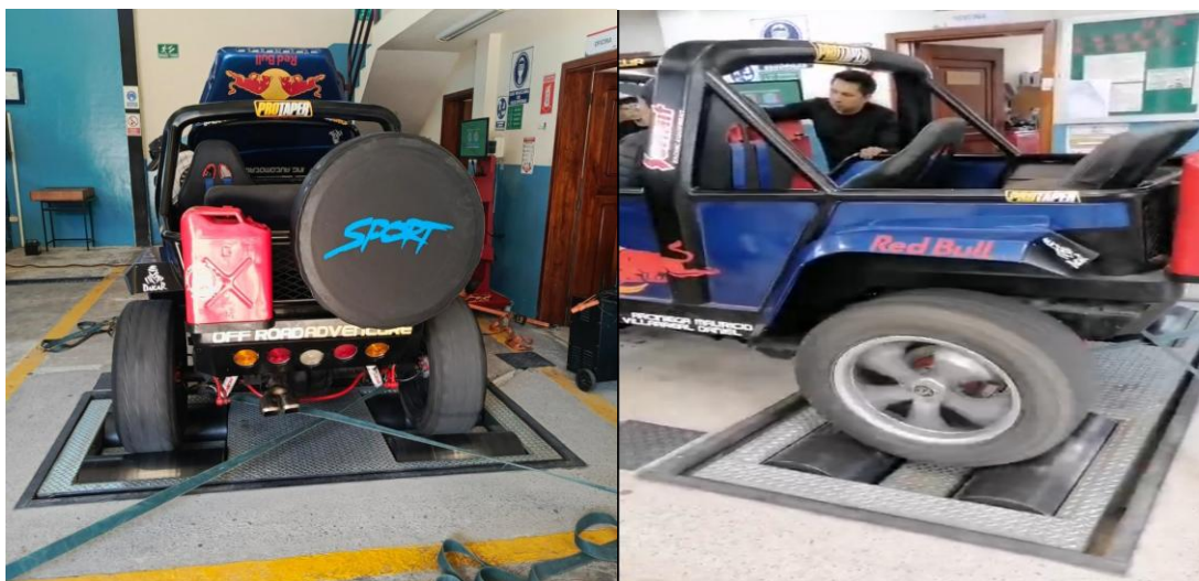
Figura 14. Procedimiento en el dinamómetro para determinar la potencia y torque
