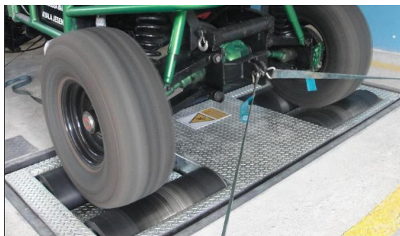
Figura 11. Dinamómetro inercial Vagma modelo BPA-V2R
