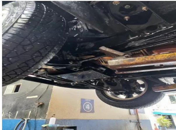
Figura 11. Inspección del sistema de escape
