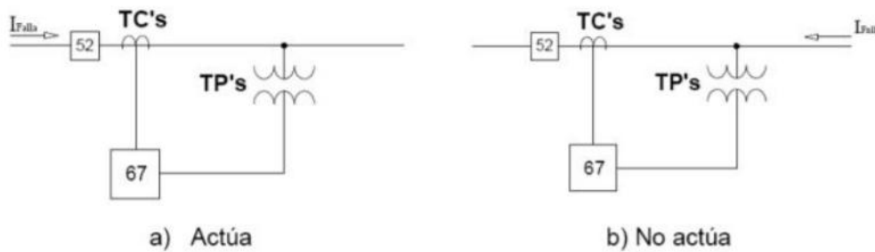
Figura 16 Dirección de la corriente de falla en el relé direccional. [20]
