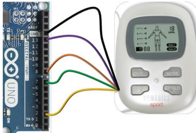
Fig. 2.7 Esquema de conexiones electroestimulador HoMEDICS-Arduino UNO [13] .
