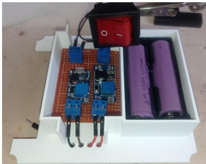
Fig. 4.24 Integración de componentes de la etapa de potencia
