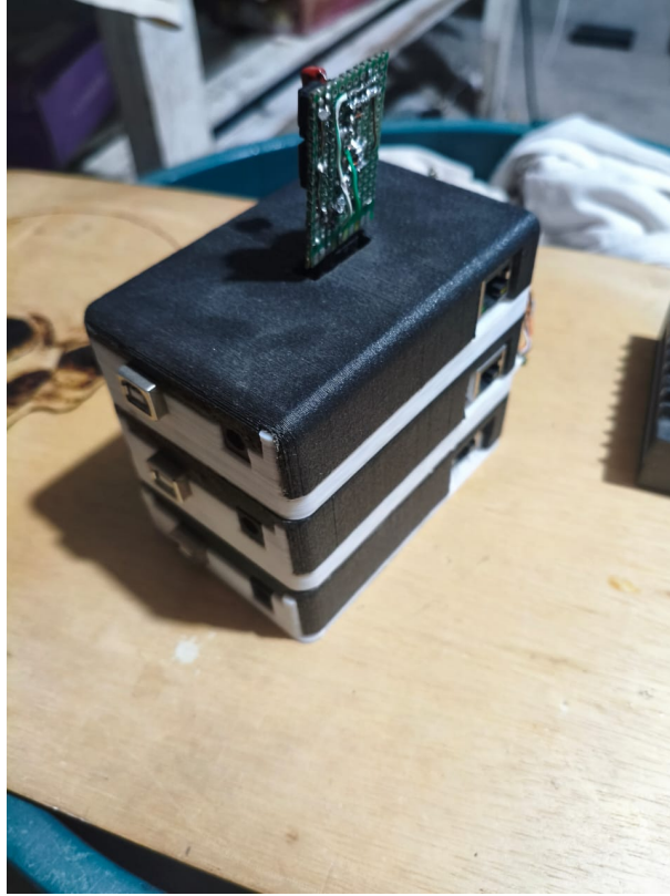
Figura 4.2: Implementación física del sistema: nodos sensor, controlador y actuador vinculados mediante un switch ethernet.
