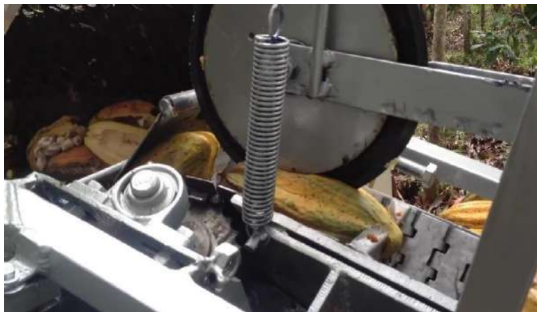
Fig. 2.2 Corte con cuchilla longitudinal en desvainadora de cacao [10]
