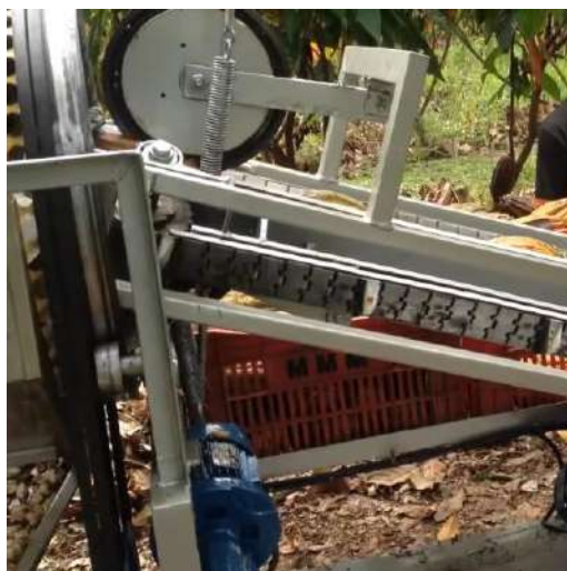
Fig. 4.1 Sistema de ingreso de mazorca de cacao al sistema de corte [10]
