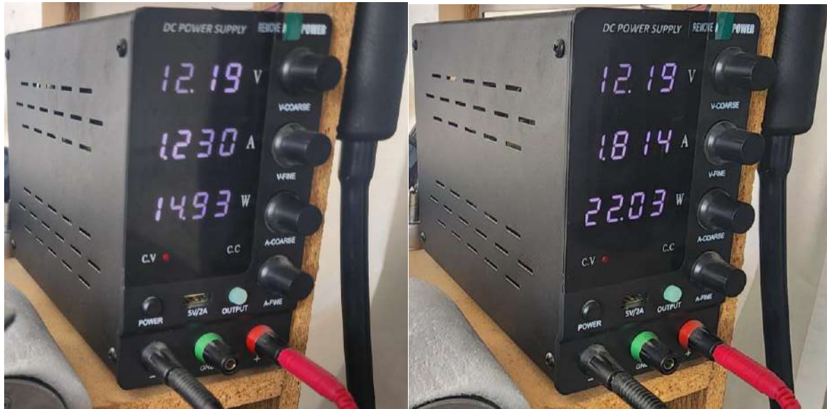
Fig. 4.44 A) Consumo a bajas RPM, B) Consumo a altas RPM
