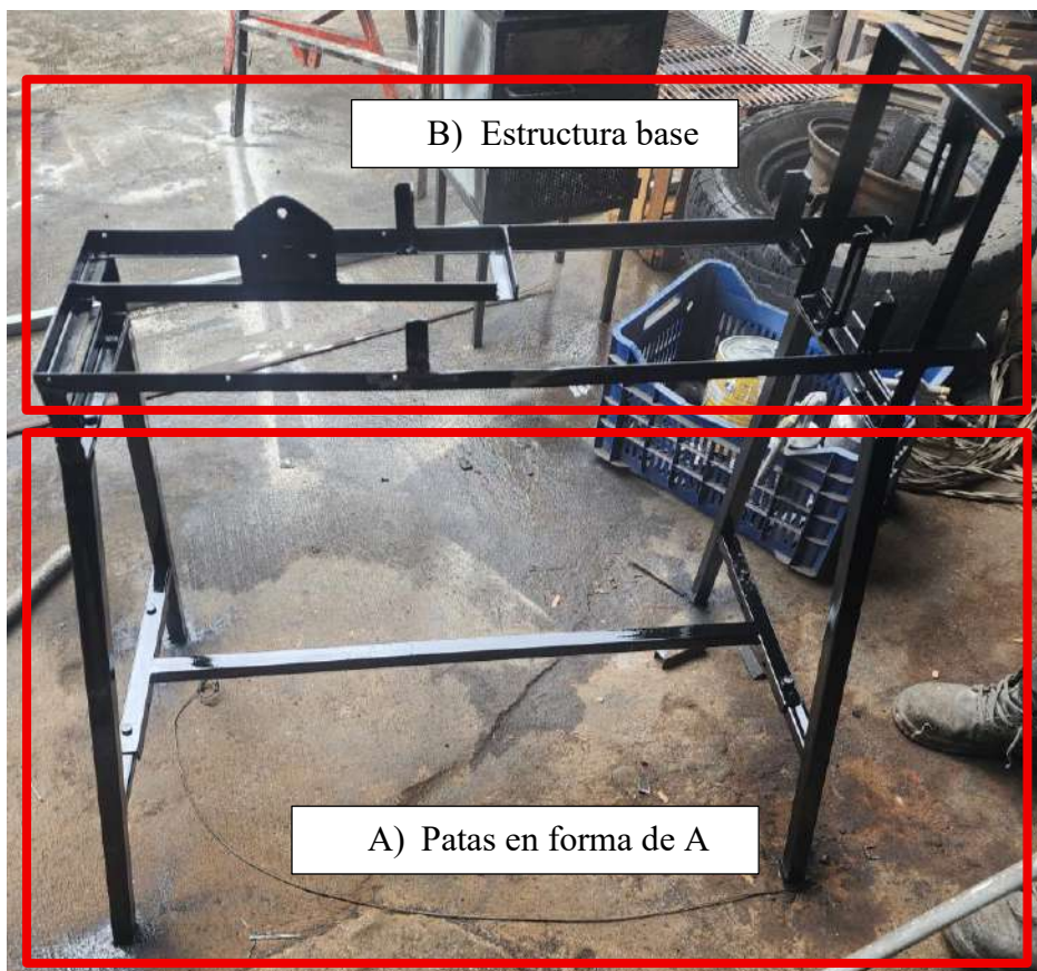
Fig. 4.35 A) Estructura base, B) Patas en forma de A del sistema de desvainado
