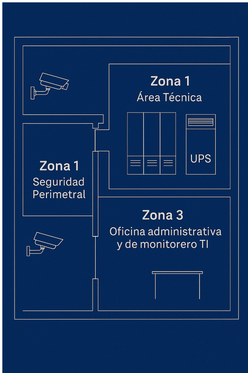
Fig. 11. Zonas de acceso del Data Center del GAD Municipal del Cantón Bolívar
