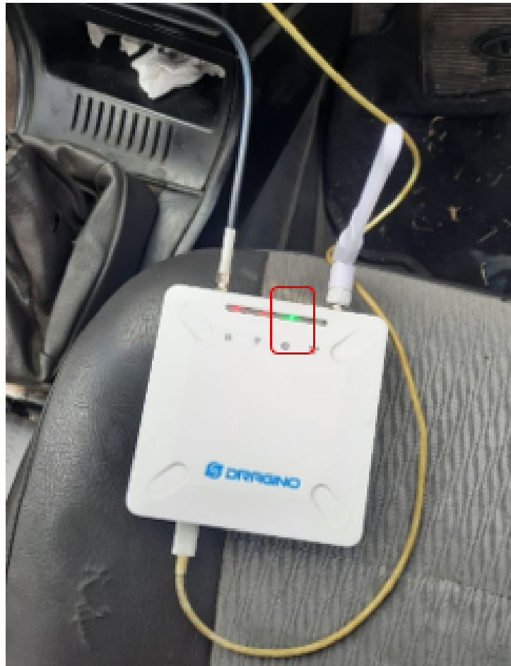
Figura 4.43: Verificación de conexión celular.
