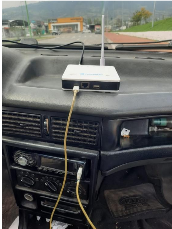
Figura 4.41: Conexión del gateway a puerto USB de un vehículo.
