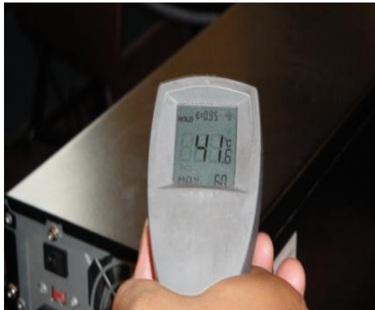
Figura 4:2 Medición de temperatura al CPU
