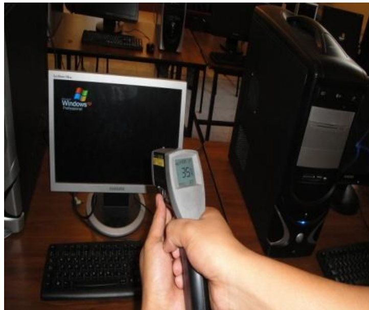
Figura 4:1 Medición de temperatura al monitor
