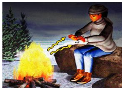
Figura. 2:3 Transferencia de calor por radiación.
