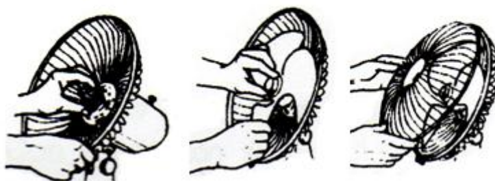
Figura 6:3 Ensamblaje del ventilador Paso 1,2 y 3. Paso 4,5 y 6. Paso 7
