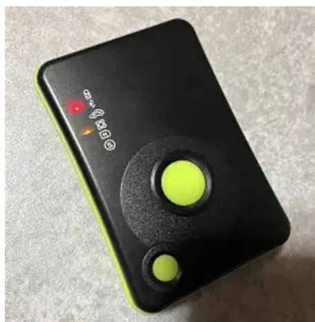
Ilustración 10. GPS Logger TSI GL-770 (velocidad y altitud).
