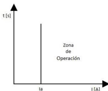
Fig. 7. Curva de operación del Relé Instantáneo [22].
