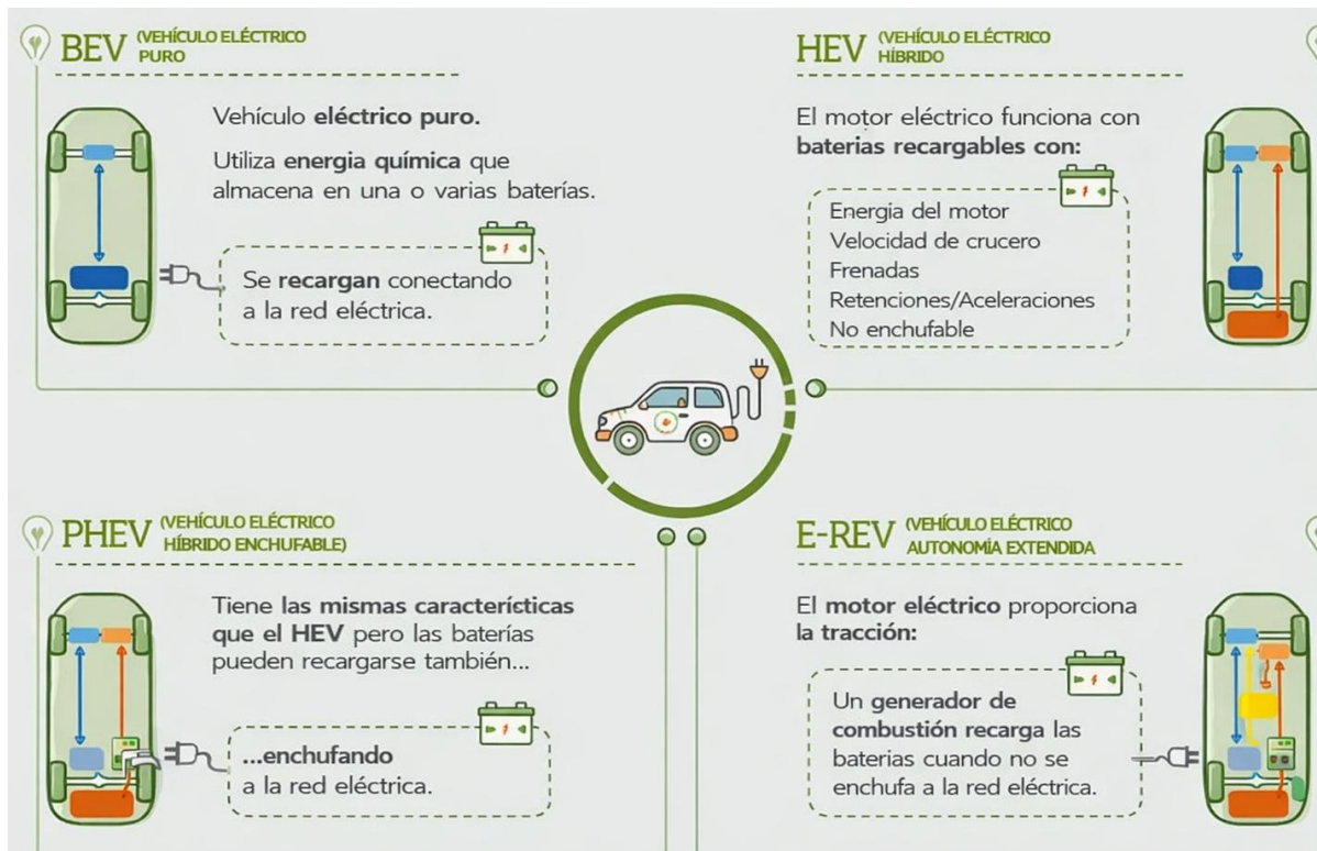
Figura 10 Tipología de Vehículos Eléctricos (Tomado de Iberdrola [32].)
