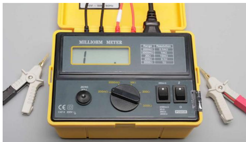
Figura 16 Milióhmetro Modelo LT-MO2001 (Tomado de Twilight [50].)
