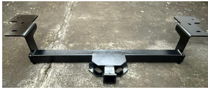
Figura 64. Barra de tiro terminada
