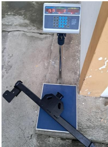
Figura 66. Pesaje de la barra de tiro
