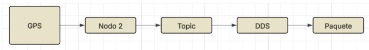
Fig. 4.4: Diagramas de bloques del nodo publicador gps.
