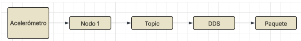
Fig. 4.3: Diagramas de bloques del nodo publicador acelerómetro.
