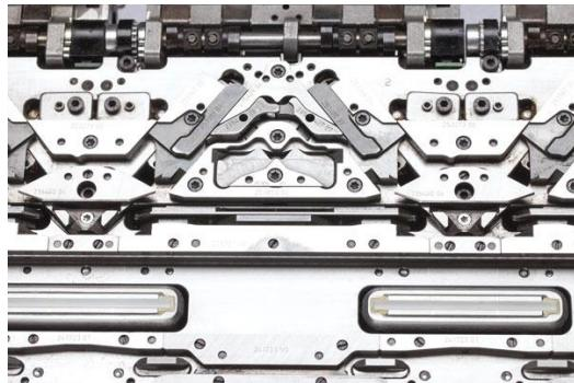
En la parte superior del sistema de tisaje se encuentran los cepillos, uno para la fontura delantera y otro para la trasera, los cuales ayudan a mantener constantemente abiertas las lengüetas de las agujas para que puedan tomar el hilo proveído por el guiahilo.
