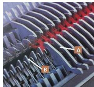
h.- La fontura de esta máquina es controlada por medio de un motor de que le permite hacer movimientos grandes de hasta 4 pulgadas y con una velocidad programable para poder realizar una gran cantidad de diseños. En la imagen se puede apreciar que la fontura de atrás está movida hacia la izquierda con respecto de la fontura delantera.
