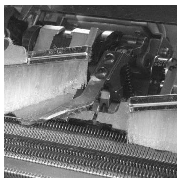
e.- Esta máquina posee un sistema de selección electromagnética que elimina el desgaste del selector y el mismo elemento puede seleccionar aguja por aguja independientemente para que salga a trabajar, a transferir o se quede sin trabajo, dependiendo de las órdenes del programa. En la figura se puede ver
