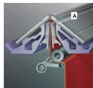
j.- Los guíahilos no difieren mayormente de los de la máquina manual en su forma y el objetivo es el de llevar el hilo directamente hasta las agujas en el momento preciso en el que lo necesiten. La máquina posee 8 guíahilos a cada lado, es decir 16 en total y tiene un dispositivo de pinzado y corte de hilo para cada hilo a cada lado y estos son llevados por pistones que son controlados electromagnéticamente para que caminen y paren en el lugar preciso y en el momento preciso que sea requerido.
