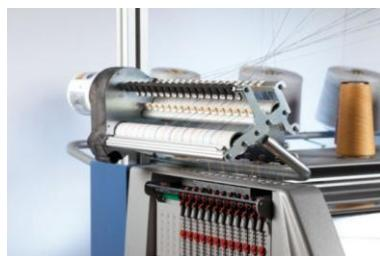
Luego de esto, en la parte inferior de los alimentadores de fricción se tiene otro sistema de recuperadores de hilo laterales que el igual que los que se encuentran la unidad de control de hilos sirven para recuperar el hilo al momento que el carro cambia de dirección para así mantenerlo siempre tensado y estos son regulables independientemente por medio de un resorte.
