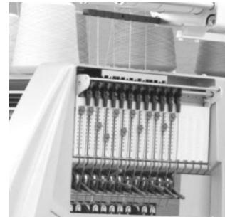
c.- La fontura que sostiene a las agujas, en este tipo de máquinas tiene además otros elementos en cada ranura o canal que ayudan al trabajo de formación de mallas, mallas retenidas, mallas cargadas, transferencia de mallas, etc. Y estos son además de la aguja (A), el talón de la aguja (B) o pieza de acoplamiento (las agujas de estas máquinas no poseen talón), la planita intermedia (C), y el selector (D).
