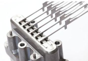
f.- Cada sistema de tisaje tiene un motor de graduación el cual comanda las levas móviles, en especial las que controlan la longitud de las mallas, estos se reajustan extremadamente rápido y se puede con ellos inclusive tener varias longitudes de mallas en cada pasada, además el mismo motor controla las transferencias de mallas.
