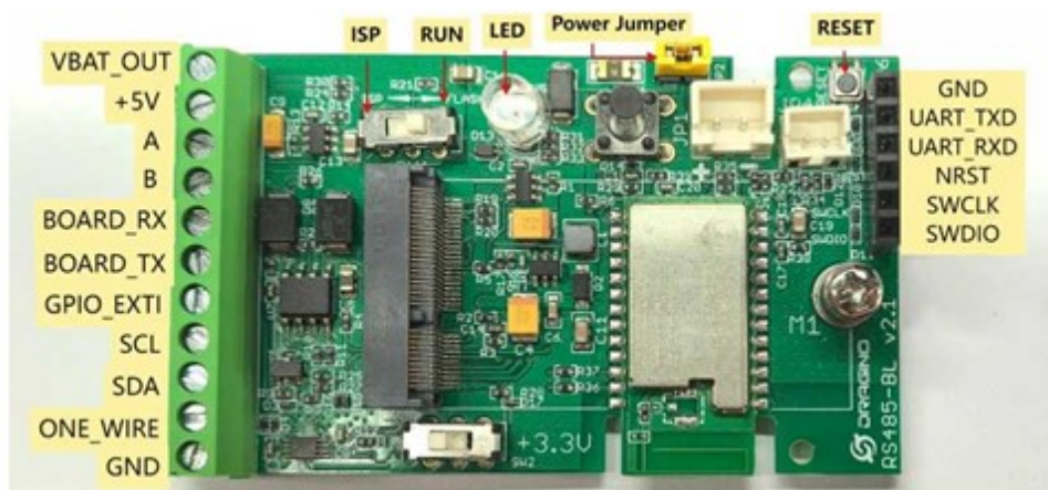
Fig. 4.7 Mapeo de pines del RS 485 LB de Dragino [44].
