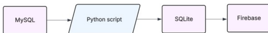
Fig. 4.15 Flujo de datos desde MySQL a Firebase mediante un script de Python.
