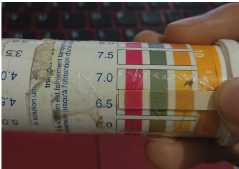
Fig. 4.20 Datos obtenidos en la medición de calibración con tiras de pH por color
