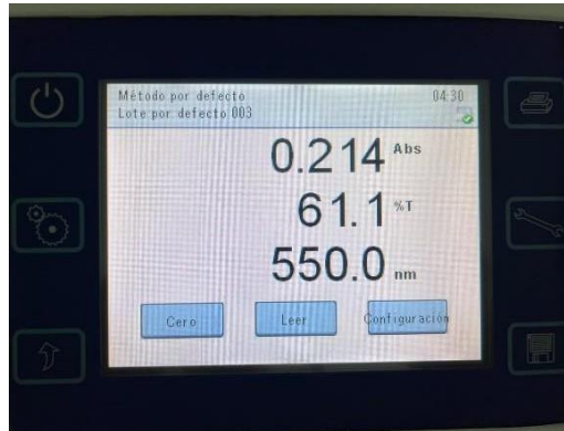
Fig. 11 UV-Vis JENWAY a 550nm mezcla del ácido y nanocarbono
