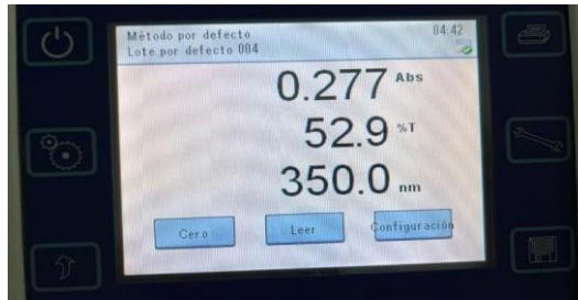
Fig. 13 UV-Vis JENWAY a 350nm mezcla del dióxido de silicio y el nanografeno
