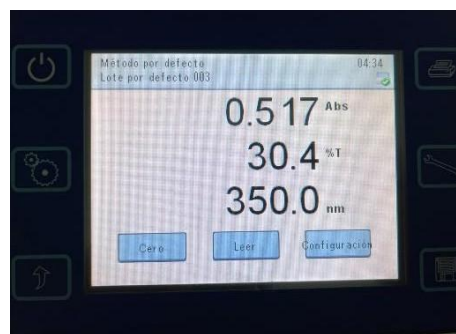
Fig. 10 UV-Vis JENWAY a 350nm mezcla del ácido y nanocarbono
