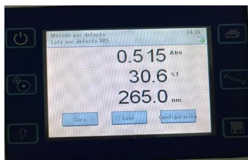
Fig. 9 UV-Vis JENWAY a 265nm mezcla del ácido y nanocarbono
