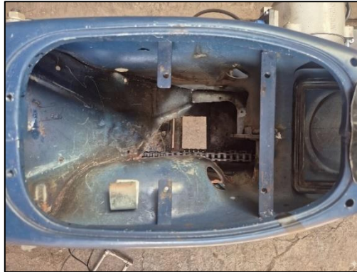
Figura 35. Alojamiento para el inversor.
