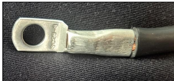
Figura 18. Cable 4 AWG con terminal de compresión de 1/4.
