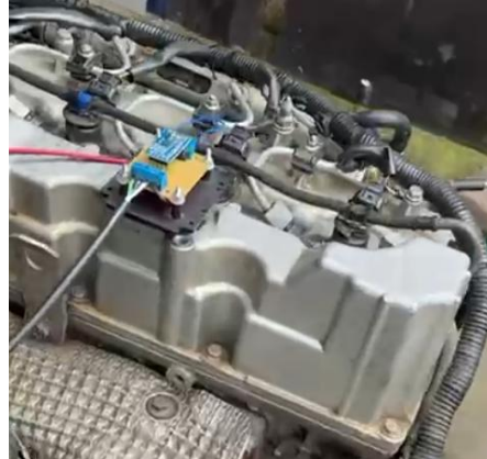
Figura 20. Implementación del acelerómetro sobre la tapa válvulas.
