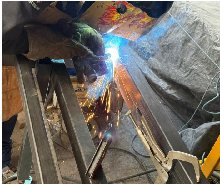
Figura 68 Proceso de Soldadura GMAW
