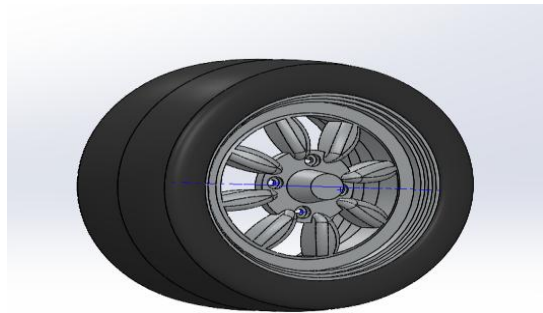
Figura 21 Modelado Aros Rin 13 y Neumáticos
