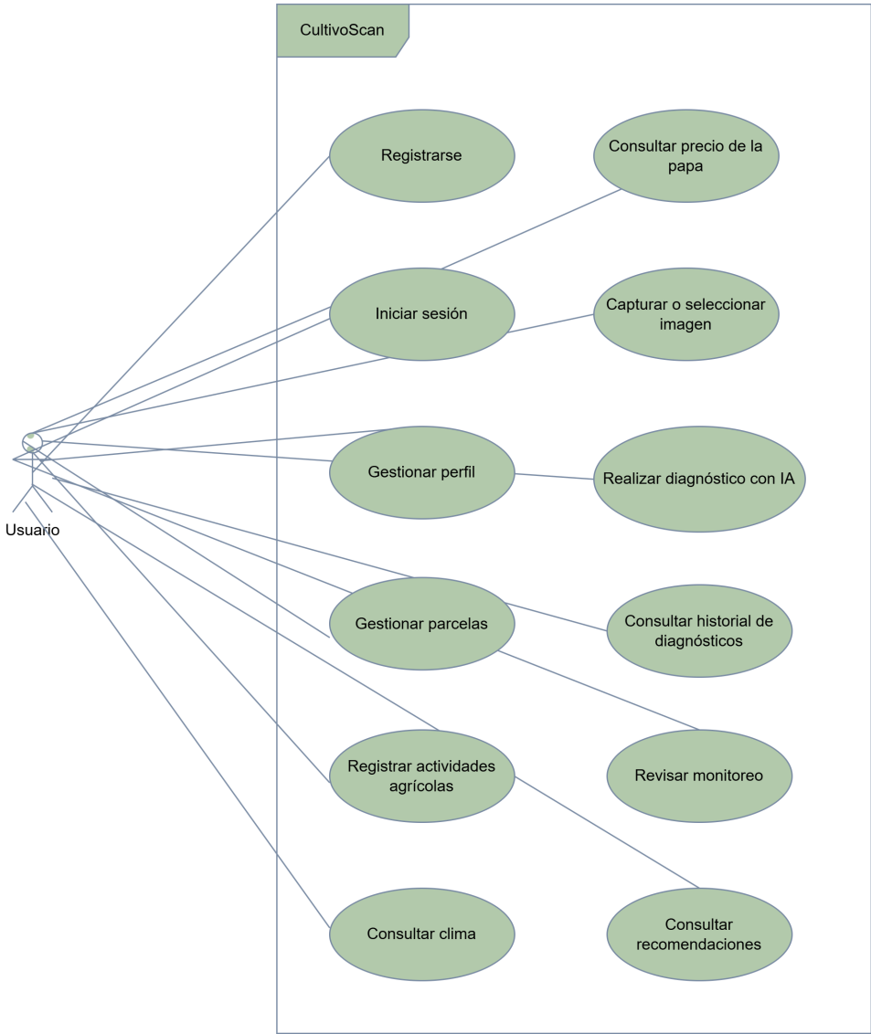
Figura 9. Diagrama general de casos de uso de la aplicación móvil CultivoScan Fuente: Elaboración propia.
