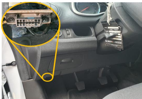
Figura 18. Ubicación del puerto OBD-II del vehículo.
