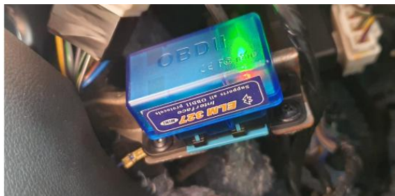
Figura 19. Verificación de operación del Interfaz OBD-II mediante el indicador LED.
