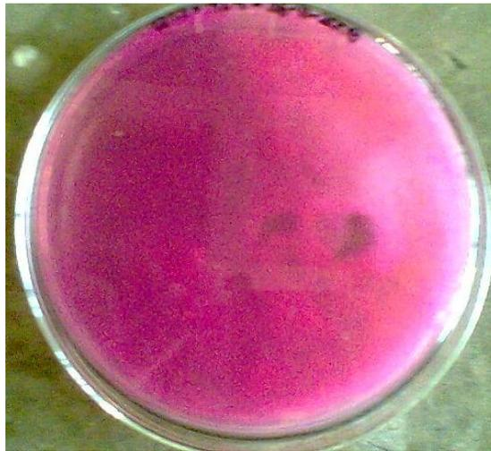
**Fotografía 4.3: Determinación de mohos y levaduras mediante norma técnica INEN 1529-10**
