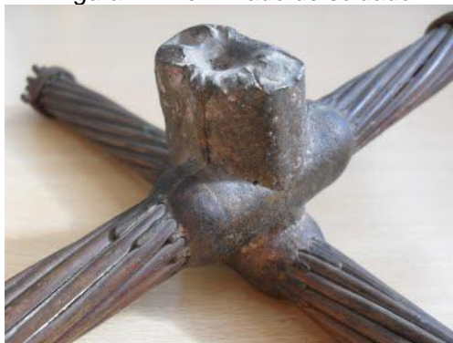
Figura 27. Terminado de soldado
