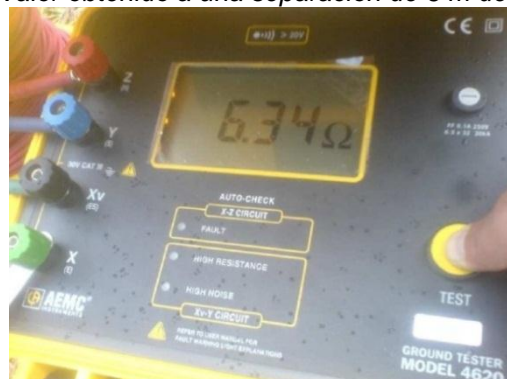
Figura 47 Valor obtenido a una separación de 6 m de pica a pica.
