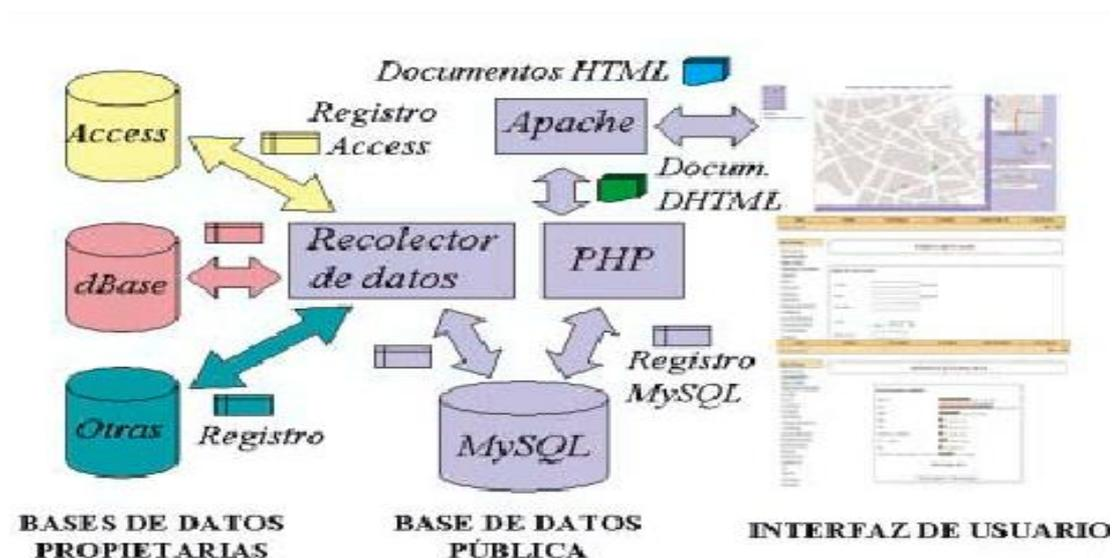
Figura 2.5 Esquema de la Arquitectura Software
