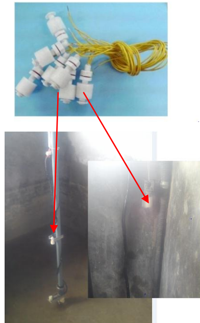
Figura 2-3: Sensor de nivel de desplazamiento
