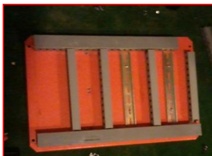
Figura 3-15 Armado de canaletas en la placa del tablero
