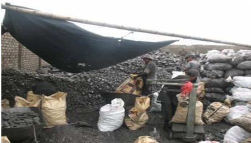
Figura 1. 1 Pesaje de carbón mediante el uso de palas y una balanza
