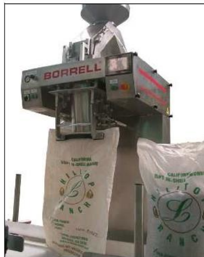
Figura 1. 16 Pesadora ensacadora (Avilés. M, 2011)
