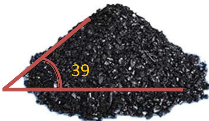
Figura 1. 18 Angulo de reposo del carbón
