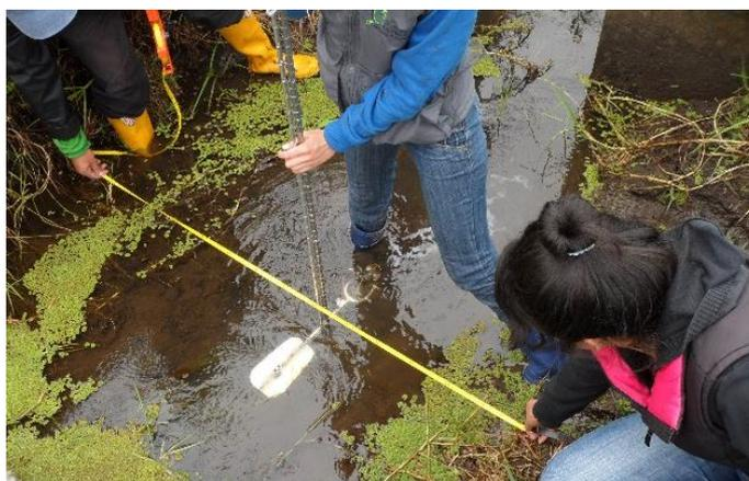
**Fotografía 3.1** Medición de caudales con el Molinete Electrónico
