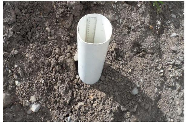
**Fotografía 26** Prueba infiltración textura moderadamente gruesa
