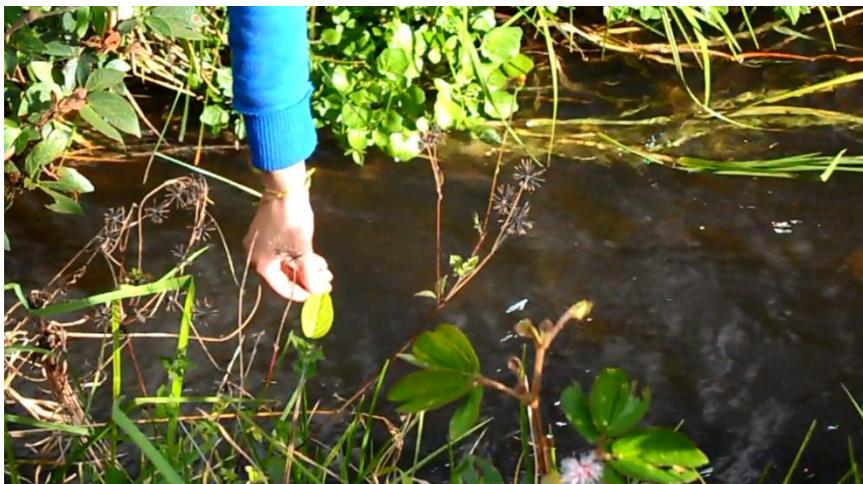
**Fotografía 3.2** Medición de caudales utilizando el método del flotador
