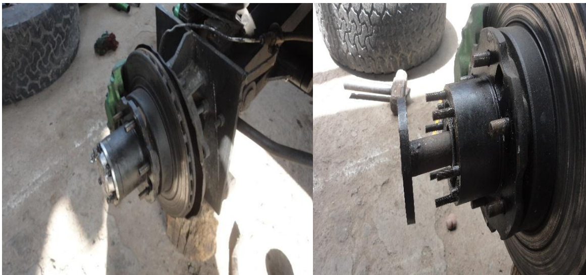
Figura 42. Conjunto manzana disco de freno.
