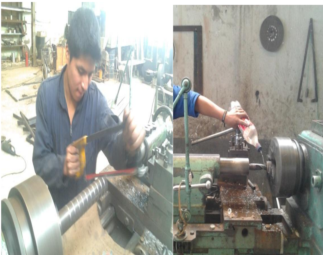
Figura 33. Corte bocín y aumento de diámetro.
