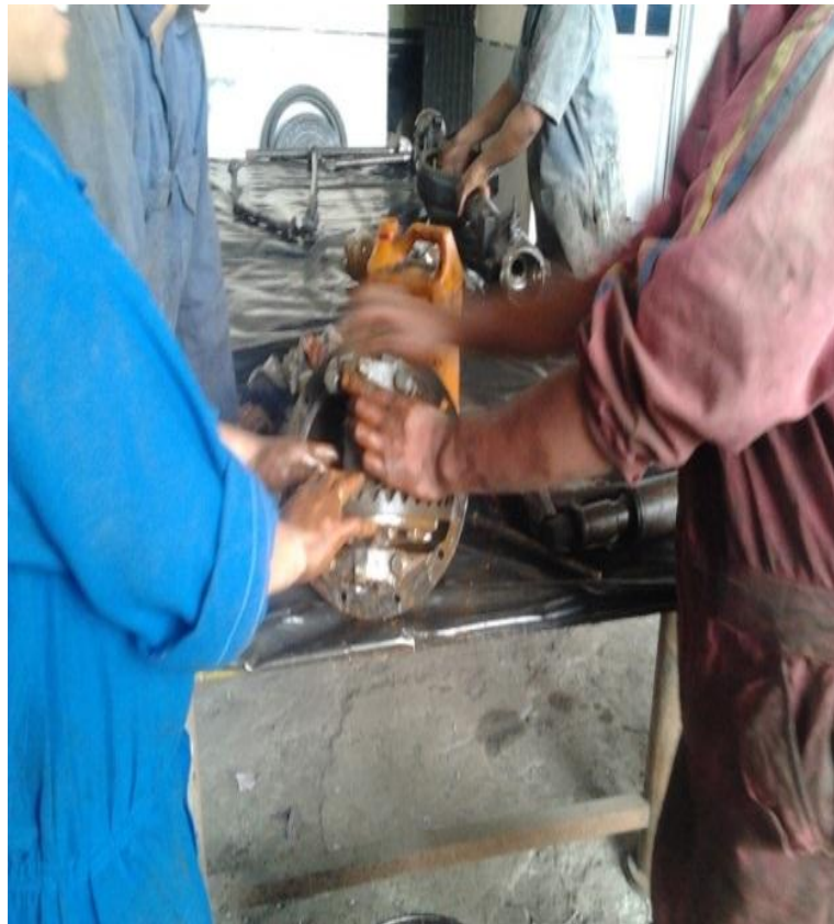
Figura 22. Desarmado del conjunto diferencial.
