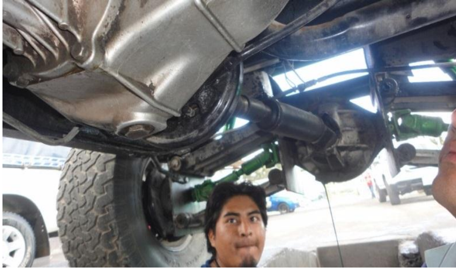
Figura 44. Inspección del sistema de transmisión independiente modificado.
