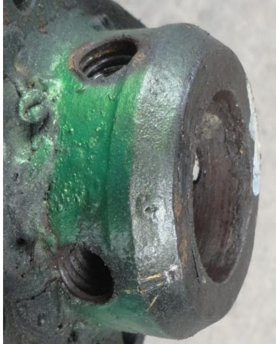
Figura 34. Bocín con perforaciones en su contorno.
