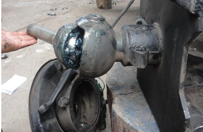
Figura 41. Engrasado de la punta homocinética Toyota Land Cruiser.
