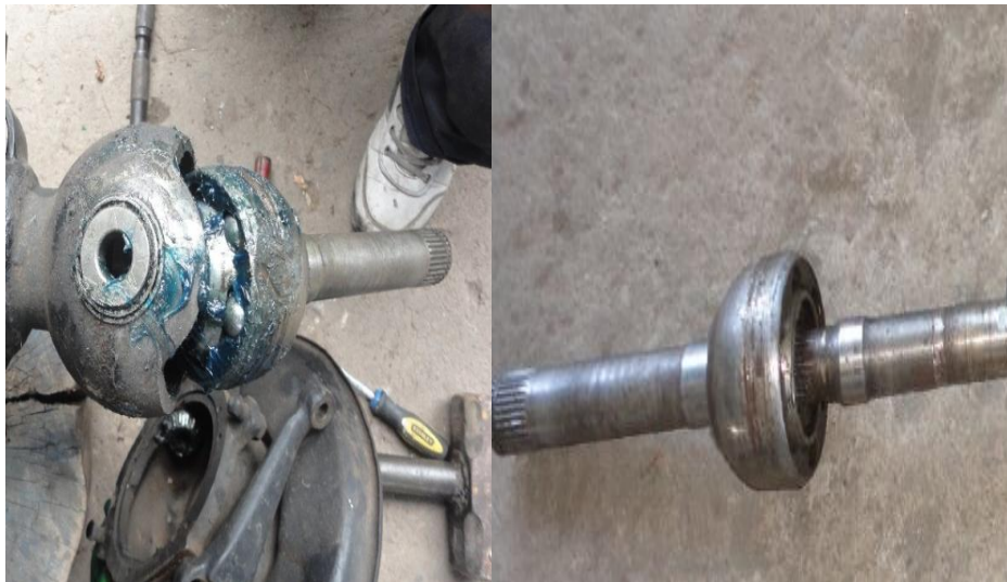
Figura 21. Punta homocinética vehículo Toyota Land Cruiser.
