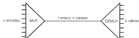
Figura 2. Esquema básico de multiplexación. Fuente: (Cisco Systems, Inc., 2001)
