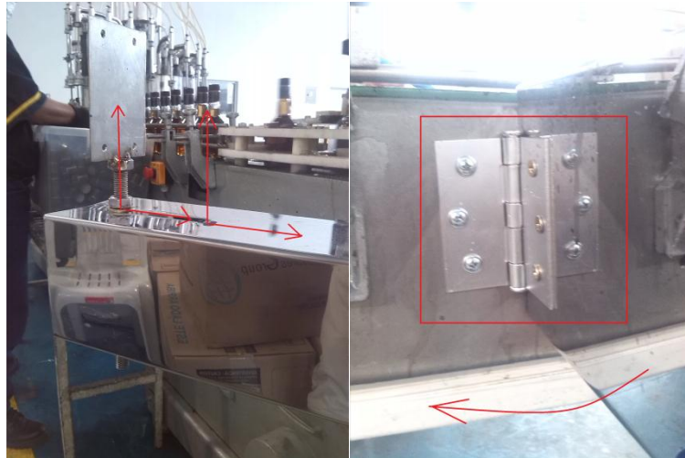
Figura 5.1 Soporte de la smart camera
