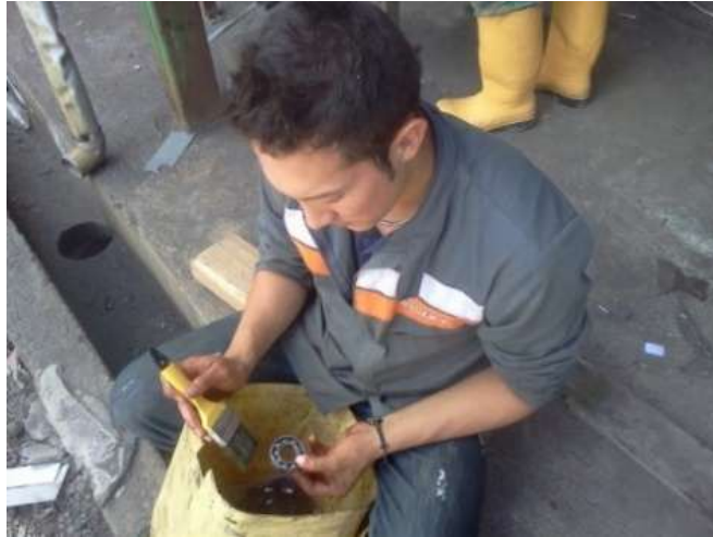
FIGURA 4.9: Mantenimiento de rodamientos
