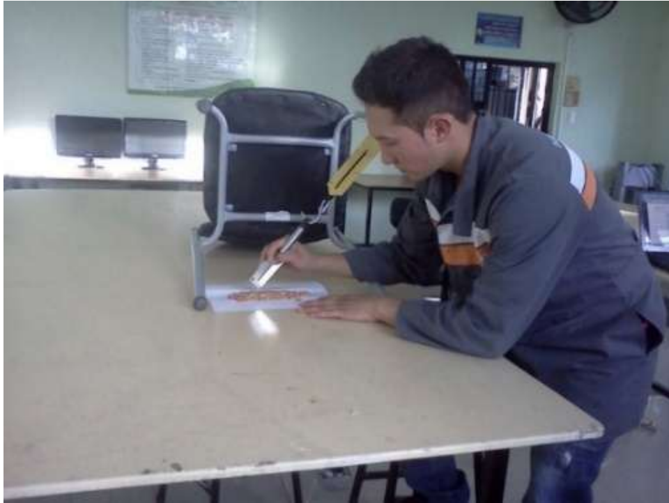
FIGURA 1.25: Ensayo efectuado para la obtención de la fuerza de corte específica
