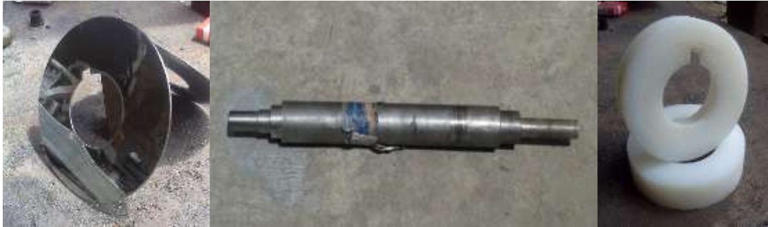
FIGURA 4.13: Partes rodillo de corte
