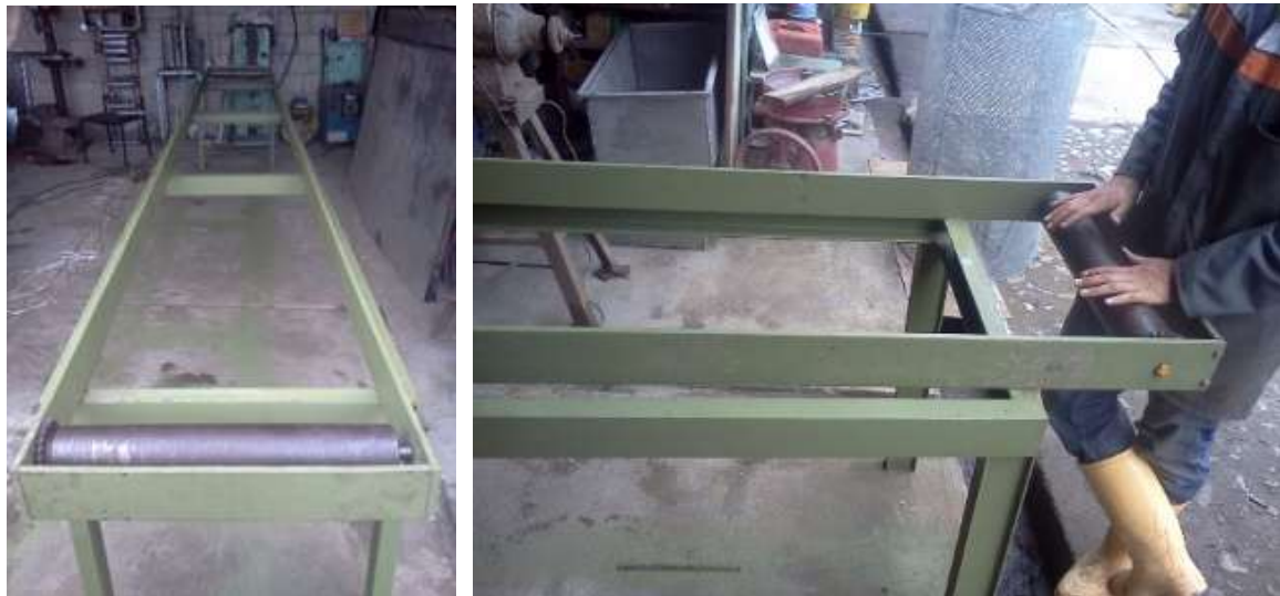
FIGURA 4.8: Montaje de rodillos
