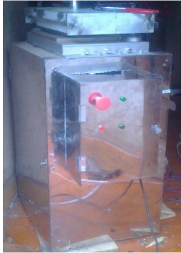
Figura 61. Ubicación del tablero de control
