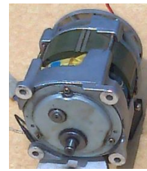
Fig 12. Aspecto exterior del motorreductor de corriente alterna
