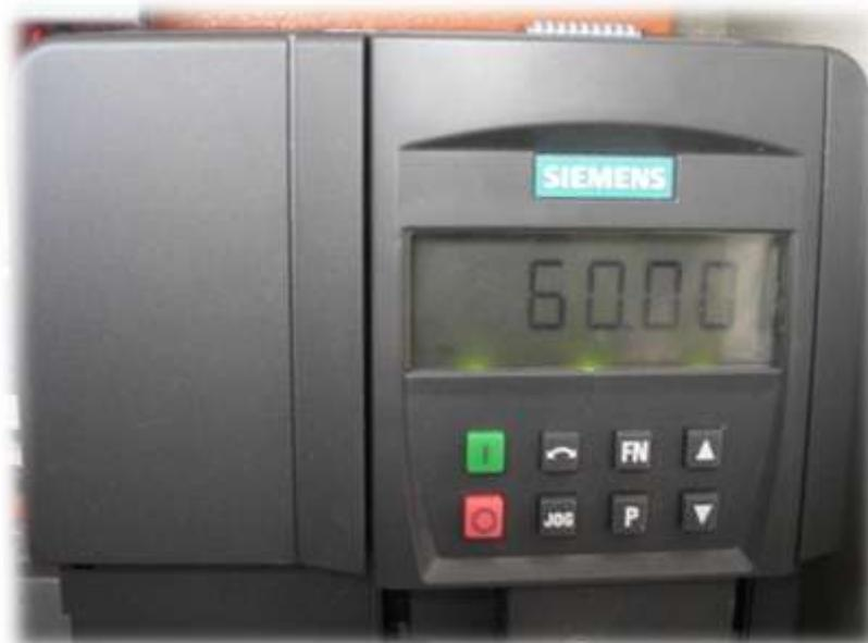
**FIGURA 92:** Frecuencia 3 mostrada en la pantalla del variador
