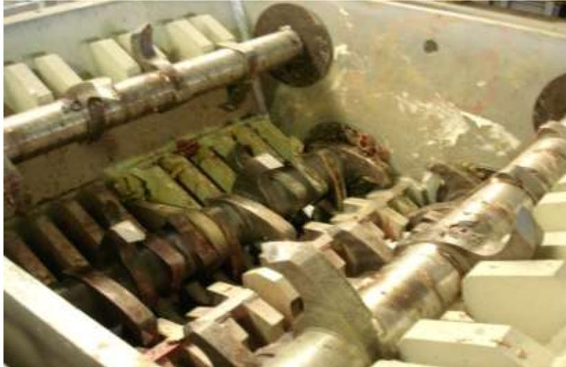
**FIGURA 4:** Trituradora de cuchillas
