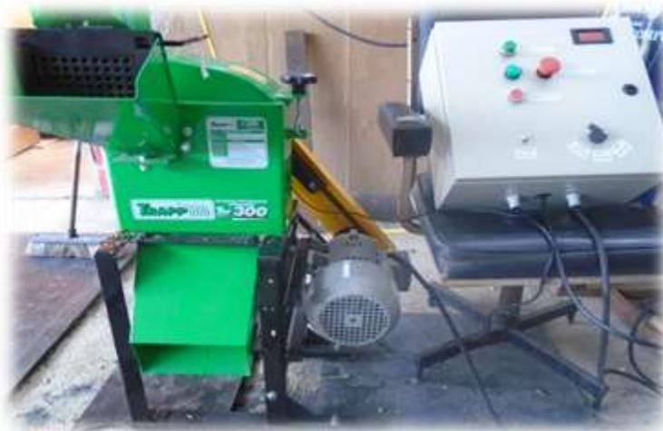
**FIGURA 105:** Máquina trituradora de plantas y desechos orgánicos para la producción de abono (Solución)
