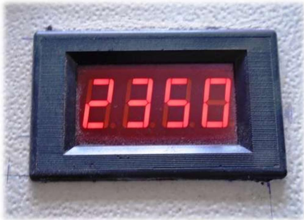
**FIGURA 83:** Velocidad 2 mostrada en la pantalla del tacómetro con un rango de error de 2%
