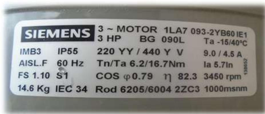
**FIGURA 39:** Placa del motor de la máquina
