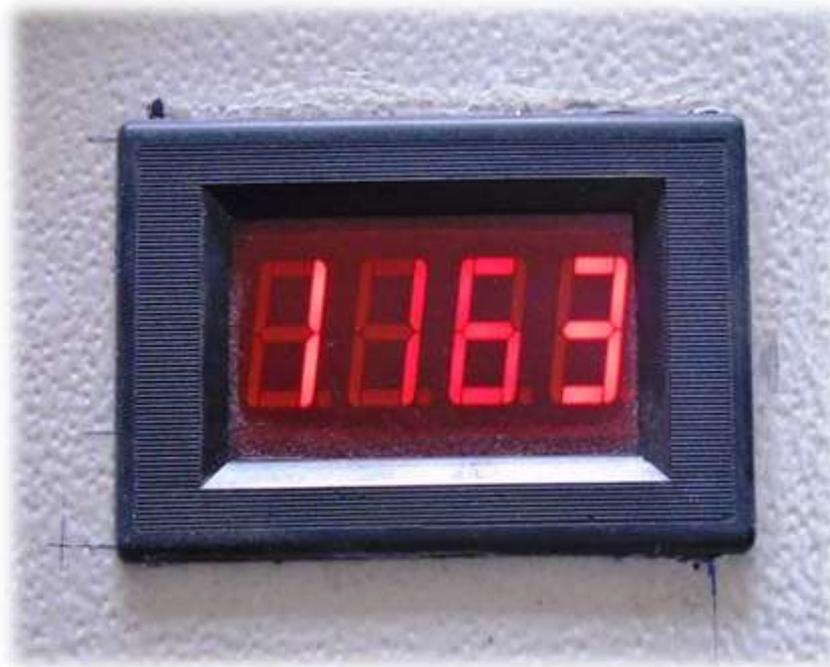
**FIGURA 73:** Velocidad 1 mostrada en la pantalla del tacómetro con un rango de error de 2%
