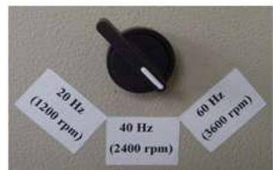
Cabe recalcar que no necesariamente hay que escoger el tipo de frecuencia mediante el movimiento del selector sino que mientras el motor esté encendido normalmente, se puede cambiar de frecuencia para que se efectúe el triturado deseado ya sea triturado grande, triturado mediano o triturado pequeño. Pero para mejor manejo seleccione primero la posición de la frecuencia y luego encienda el motor.
