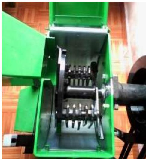
**FIGURA 106:** Cuchillas De La Máquina
