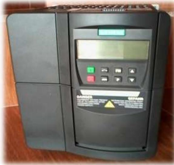
**FIGURA 13:** Variador de frecuencia SIEMENS Micromaster MM440
