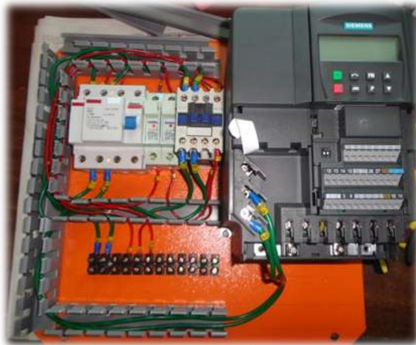
**FIGURA 67:** Cableado del tablero electrónico
