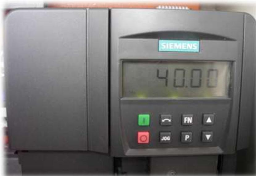
**FIGURA 82:** Frecuencia 2 mostrada en la pantalla del variador
